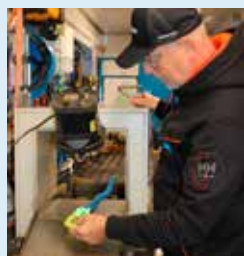
Magnafluxkontroll. För sprickindikering.
